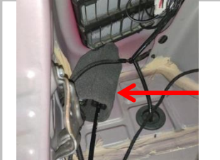
2.5 把驱动盒包好防震泡棉后，插好线束接口，放在左侧内饰板里面（需先拆开左内饰板）
