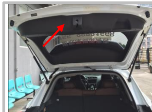
2.1 接信号线：拆下车尾门塑料装饰件（箭头）；
