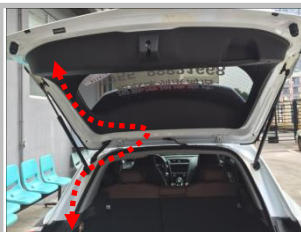
2.3 电源线布线：把电源线沿着后门原车线束引到锁扣处，并把线固定好；（虚线）
