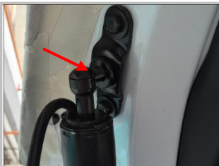
1.5 另一头撑杆同样还原安装在尾门端支架上，撑杆进线端在尾门端；
