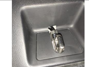
2.6 把后踏盖板与小盖板按上图修剪好（与门锁主体不干涉即可）后还原安装好，门锁安装完成；
