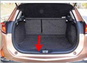
2.1 拆下原车后踏盖板
