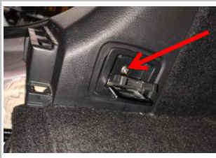
2.4 拆下上图螺丝，拆开左侧内饰板
