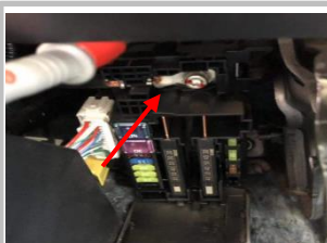
2.9 布撑杆正极线：找到原车正极螺栓；
