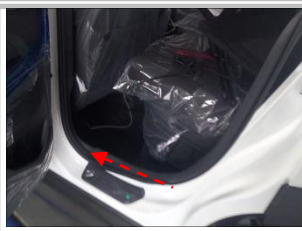
2.5 布撑杆正极线、解码器 控制信号线：拆卸左侧迎宾踏板胶条，线束穿过后门迎宾踏板胶条；（虚线）
