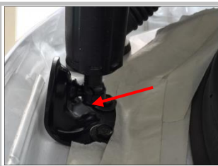
1.4 用我司撑杆还原装在原车车身端支架上，注意区分左右撑杆；
