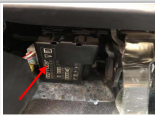
2.8 布撑杆正极线：找到原车保险盒，打开盖子；
