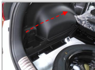
2.4 布撑杆正极线、解码器 控制信号线：穿过后门迎宾踏板胶条内侧延伸至尾箱预留合适线束连接；
